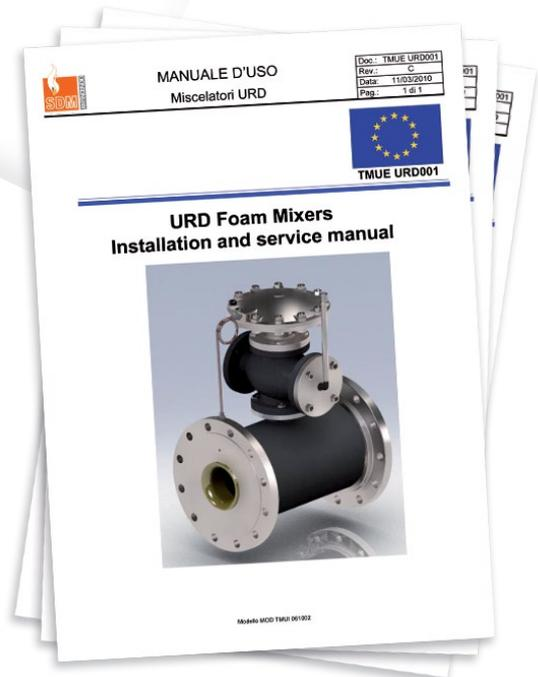
Queste unità sono state progettate per sostituire i premiscelatori a membrana ove sia disponibile un sistema elettrico di alimentazione di emergenza, e funzionano unitamente ad un miscelatore bilanciato nel quale il concentrato schiumogeno viene fornito da un semplice serbatoio a pressione atmosferica per mezzo di una pompa azionata da un motore elettrico. I vantaggi offerti da queste unità indipendenti sono davvero notevoli in termini di investimento iniziale:
